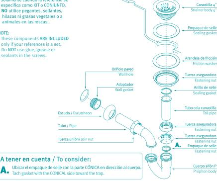
Ubicar el empague de selle con la parte CÓNICA en dirección al cuerpo. Tach gasket with the CONICAL side toward the trap.
